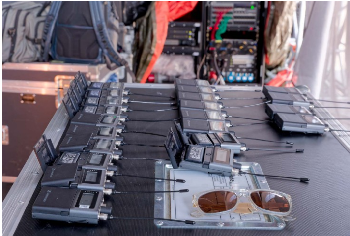
Kleiner Fußabdruck: Eine einzige 19" Base Station spielt die 14 Stereo-In-Ear-Mixe der Produktion aus
