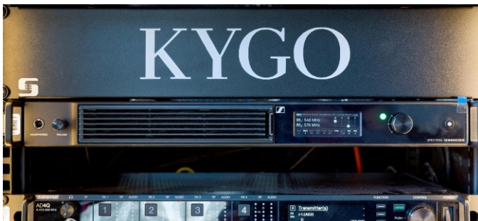
Die Spectera Base Station am Monitorplatz arbeitete mit zwei HF- Breitbandkanälen mit den Mittenfrequenzen 546 und 578 MHz
